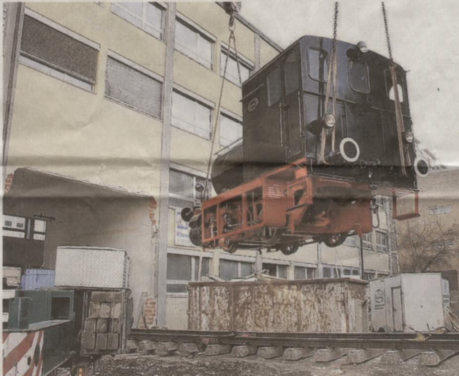
„Sie schwebt!“. Durch ein Mauerloch ist die alte Lok auf ein provisorisches Gleis gezogen worden. Nun heben zwei Autokrane sie auf einen Tieflader.
